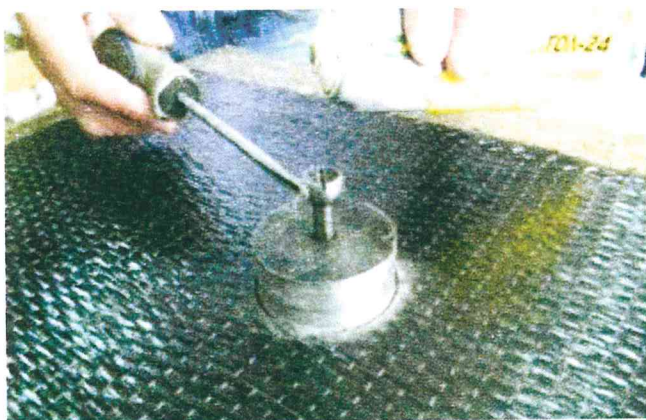
Рисунок Д.5 – Обуривание СВА вокруг «пятачка»
