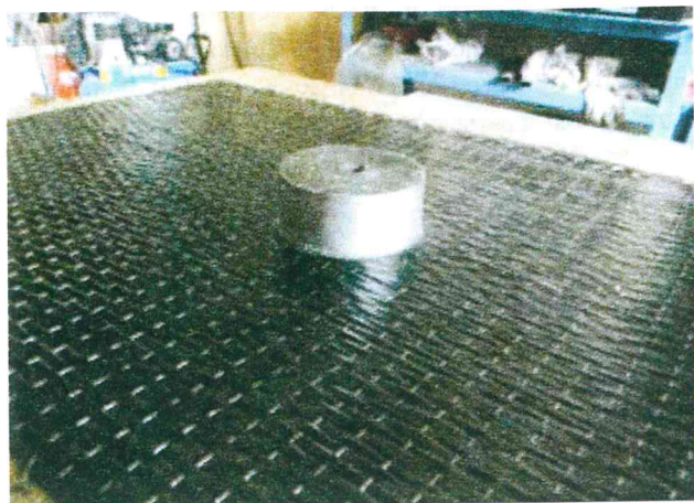
Рисунок Д.4 – «Пятачок», наклеенный на элемент СВА
